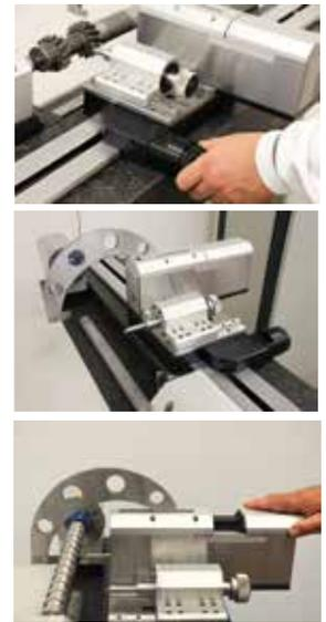
**GIOTTO-MAN** es un banco de medición manual para ejes, diseñado para ser ubicado en la planta de producción para una retroalimentación inmediata sobre los límites de tolerancia. El diámetro y la longitud del eje de medición son introducidos por el operador. La repetibilidad está asegurada por un sistema mecánico dedicado.
