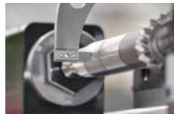
**GIOTTO MATIC** est un banc à structure modulaire, pour la mesure d'arbres et d'autres pièces cylindriques. Développé avec des producteurs d'arbres de transmission, il permet un contrôle qualité sans l'influence de l'utilisateur grâce à une force de mesure constante.
